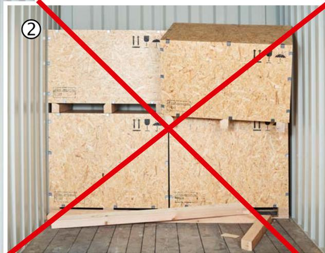
1. *Diferentes tipos de vigas de madera ancladas en el contenedor podrían romperse, deslizarse o dañar el contenedor*
