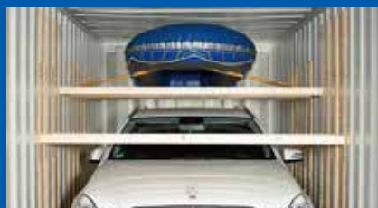
2 支柱に掘られた溝に横棒を挿し込む
