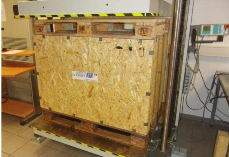
Abb. 6 OSB-Kiste 3 während der Stauchdruckprüfung
