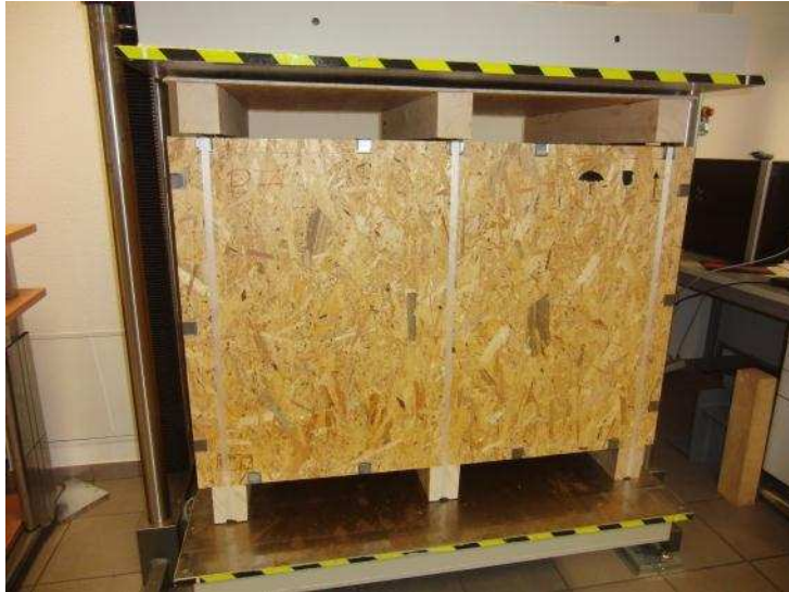
Abb. 14 OSB-Kiste 7 während der Stauchdruckprüfung
