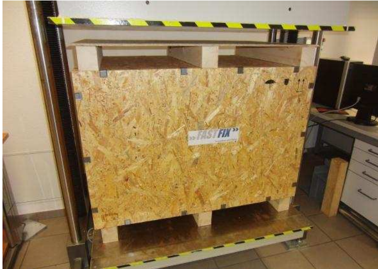
Abb. 12 OSB-Kiste 6 während der Stauchdruckprüfung
