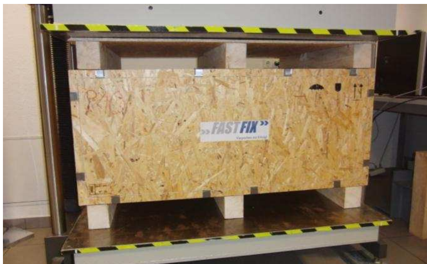
Abb. 20 OSB-Kiste 10 während der Stauchdruckprüfung
