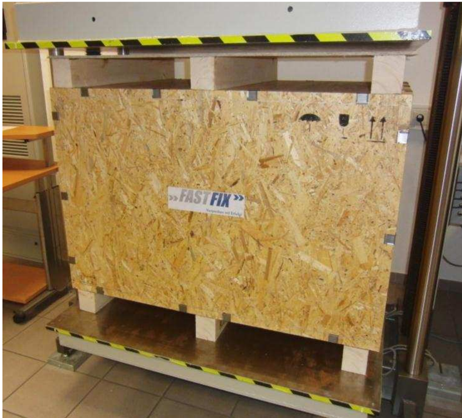
Abb. 2 OSB-Kiste 1 während der Stauchdruckprüfung
