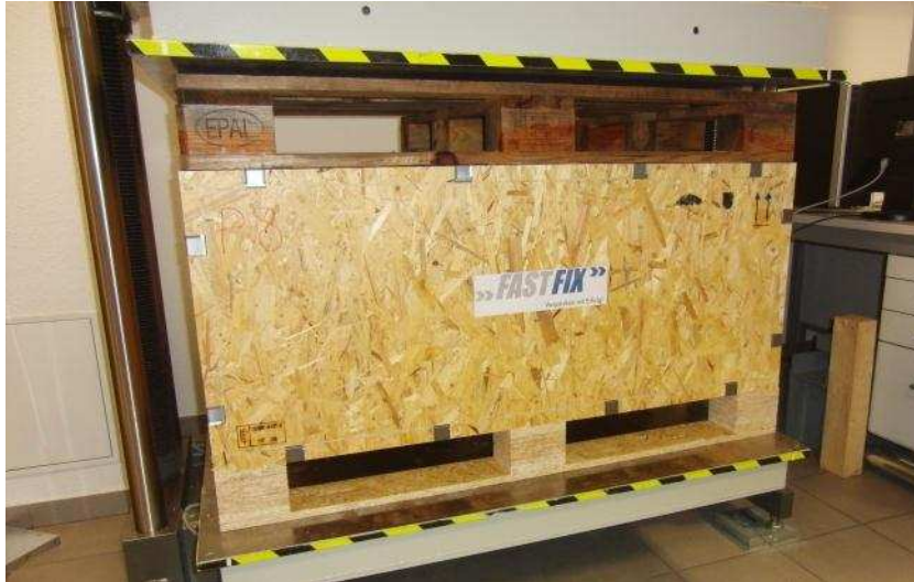
Abb. 16 OSB-Kiste 8 während der Stauchdruckprüfung
