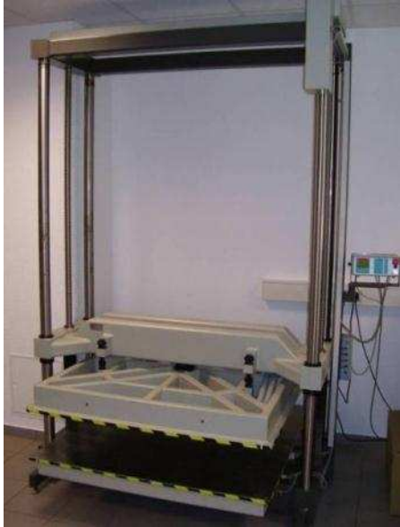
Abb. 1 Stauchdruckpresse TIRAtest 2750 BCT (Hersteller: TIRA)
