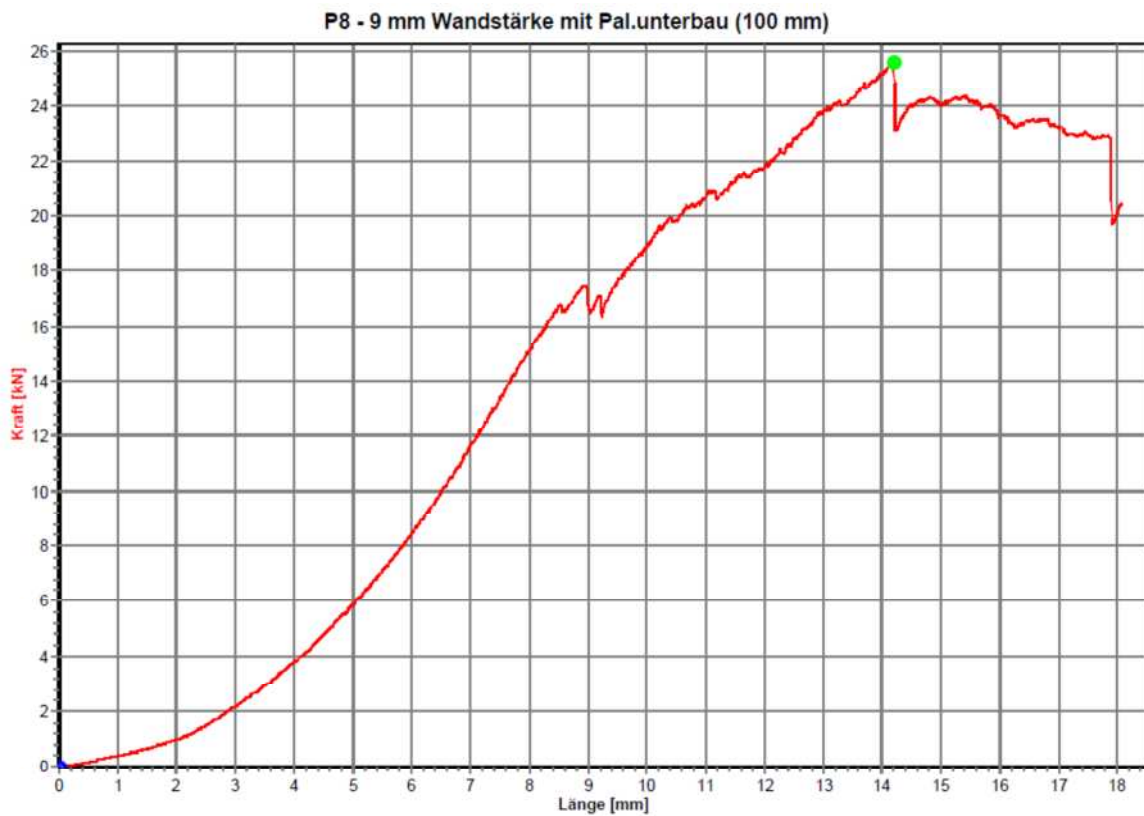
Abb. 16 OSB-Kiste 8 während der Stauchdruckprüfung
