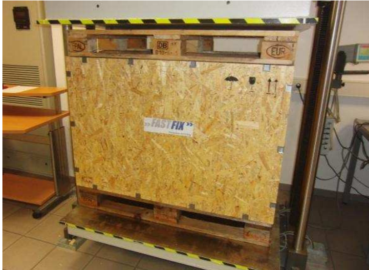
Abb. 8 OSB-Kiste 4 während der Stauchdruckprüfung
