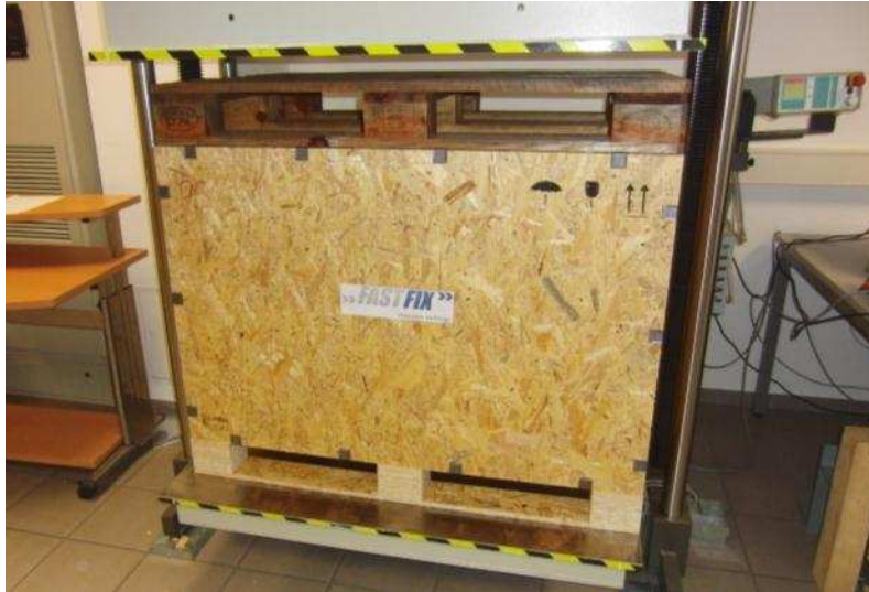
Abb. 10 OSB-Kiste 5 während der Stauchdruckprüfung
