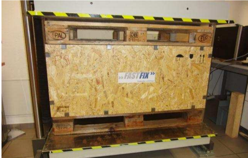
Abb. 18 OSB-Kiste 9 während der Stauchdruckprüfung
