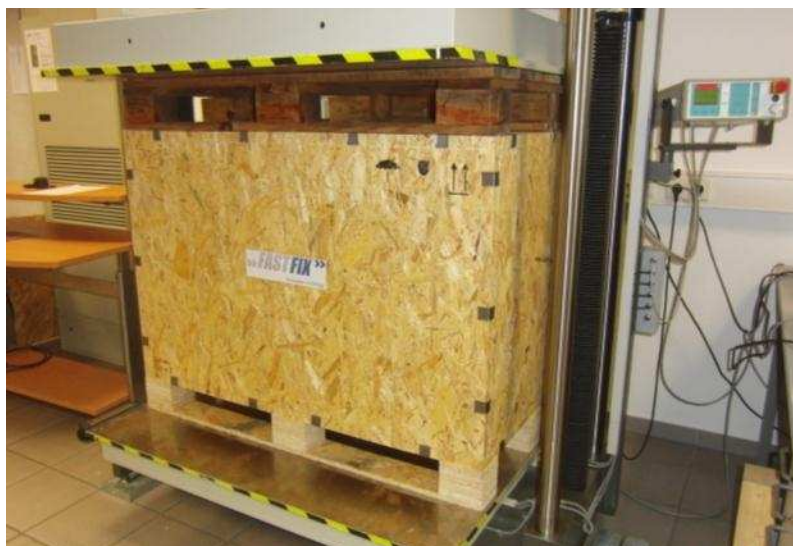
Abb. 4 OSB-Kiste 2 während der Stauchdruckprüfung
