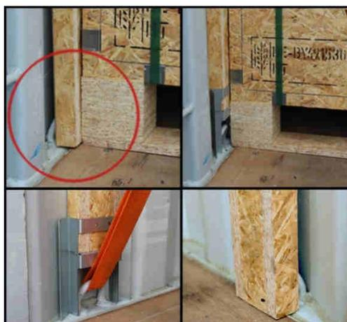
Der **UPLash** sorgt in Sicken mit Lashpunkten für Formschluss. Die um 10 cm gekürzte Stütze wird ohne Traglastverluste eingebaut und auch der Zurrpunkt bleibt verwendbar.
