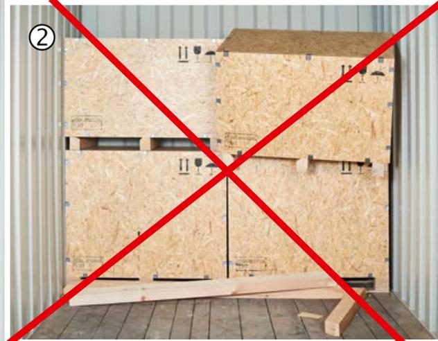
1. Eingespreizte Stauhölzer können brechen, herausrutschen oder den Container beschädigen
