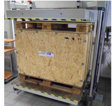
Im Test weist die Kiste mit 15 mm Materialstärke auf EURO-Palette den höchsten Belastungswert auf – gefolgt von der Kiste mit OSB-Unterbau (4-seitig unterfahrbar) mit 100 mm breiten Kufen. Kisten mit 80 mm breiten Massivholzkufen (2-seitig unterfahrbar) erreichen folglich den geringsten Belastungswert. Die Werte vermindern sich weiter mit geringer werdender Materialstärke.
