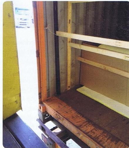
stellt, in die sie sich flächenbündig einfügen. Die Querriegel, deren Enden in den Ausnehmungen der Stützen platziert werden, verbinden die Stützen miteinander und sichern das System dabei spannungslos. Ein Einspreizen von Kanthölzern, wie bisher in der Praxis üblich, entfällt.
