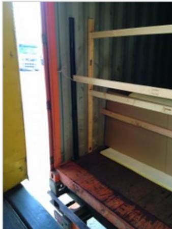
Um das Beförderungsgut zu sichern und den Container zu unterteilen, können Abtrennungen in horizontaler, in vertikaler oder in beide Richtungen vorgenommen werden. (Foto: Fairfix)
