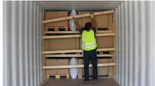
**Bild 7** (Quelle: Fairfix) Montage Rückhaltesystem
