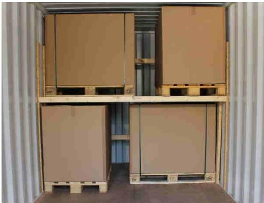
**Bild 8** (Quelle: Fairfix) Corflex-System 1-Ebene
