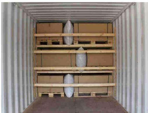
**Bild 10** (Quelle: Fairfix) 2-Ebenen, mit Stausäcken und Rückhaltesicherung
