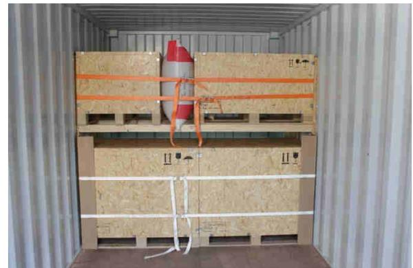
**Bild 9** (Quelle: Fairfix) Corflex-System 1-Ebene, mit Stausack&Lashing
