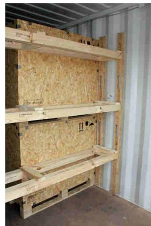
**Bild 11** (Quelle: Fairfix) 2 Gekoppelte Rückhalte-/Anschlagsysteme
