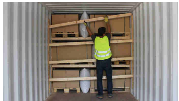
Bild 10 (Quelle: Fairfax) Montage Rückhaltesystem
