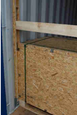
Bild 7 (Quelle; Fairfax): Formschluss mit UPLash
