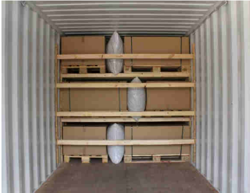
Bild 13 (Quelle: Fairfix) 2-Ebenen, mit Stausäcken und Rückhaltesicherung
