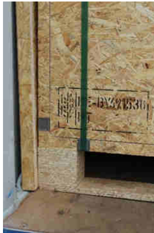
Bild 8 (Quelle; Fairfax): kein Formschluss ohne UPLash
